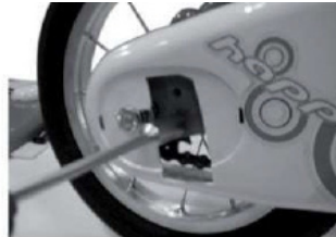
fig. 3 Quite los tornillos de fijación del cuadro con una llave 8, 10 o específica.
