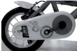
fig. 2 Verifique que los dos tornillos de la rueda estabilizadora estén enroscados al cuadro.
