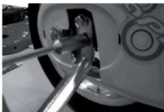
fig. 5 Enrosque también el tornillo inferior con un par de ajuste de 10 Nm.
