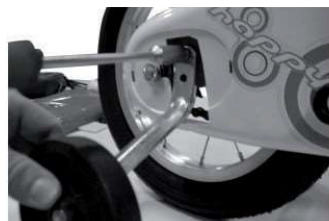
fig. 4 Posizionare lo stabilizzatore in corrispondenza dei 2 fori filettati del telaio. Avvitare la vite superiore della piastra, con coppia di serraggio di 10 Nm. Questa operazione deve essere poi ripetuta anche dal lato opposto della bicicletta.
