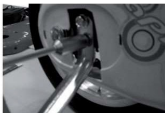
fig. 5 Avvitare anche la vite inferiore con coppia di serraggio di 10 Nm.
