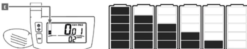
5 barres s'affichent à l'écran lorsque la batterie est complètement chargée. Les encoches s'éteignent progressivement au fur et à mesure que la charge diminue. Lorsque la batterie est faible, la dernière encoche clignote pour vous avertir que la batterie doit être rechargée.
