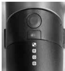
6.3. En fonctionnement normal, un autre indicateur placé sur le coude du guidon fournira à l'utilisateur une indication instantanée de l'état énergétique de la batterie.
