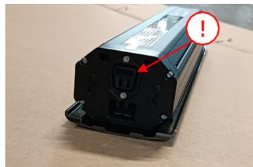
Figura 13 – Presa per la ricarica sulla batteria
