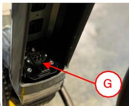
Figura 11 – Contatti e perni di blocco inferiore
