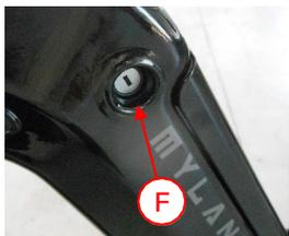
Figura 10 – Chiave bloccaggio batteria
