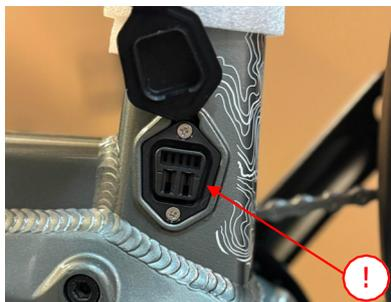
Figura 14 – Presa per la ricarica sul telaio della bicicletta
