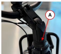
Figura 1 - Vite fissaggio rotazione manubrio
