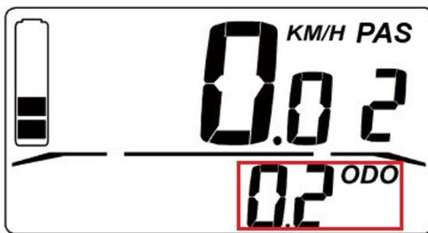
Figure 7 - Distance totale (ODO) ou distance partielle (TRIP) indiquée en km/h.
