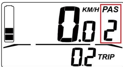
Figure 8 - Indication du niveau d'assistance au pédalage PAS.
