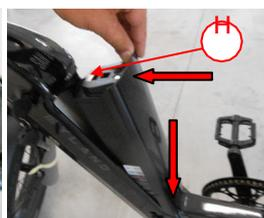
Figure 12 – Goupille de verrouillage supérieure
