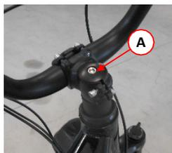
Figure 1 - Vis de fixation de la rotation du guidon
