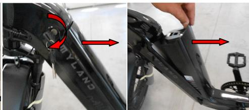
Figure 3 - Compartiment d'installation de la batterie
