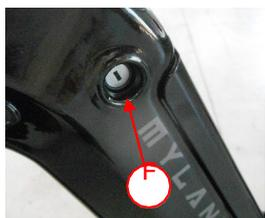
Figure 10 – Touche de verrouillage de la batterie.
