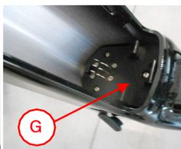
Figure 11 – Contacts et goupilles de verrouillage inférieures.
