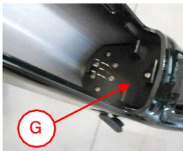
Figura 11 – Contactos y pasadores de bloqueo inferiores.
