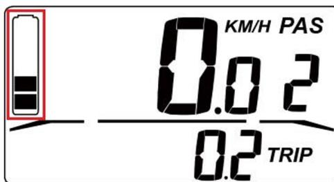
Figura 9 – Indicación del nivel de carga de la batería.
