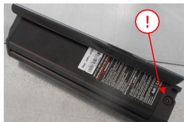
Figura 13 – Toma de carga de la batería
