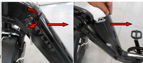
Figura 3 - Compartimento de instalación de la batería.
