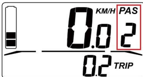
Figura 8 – Indicación del nivel de asistencia al pedaleo PAS.
