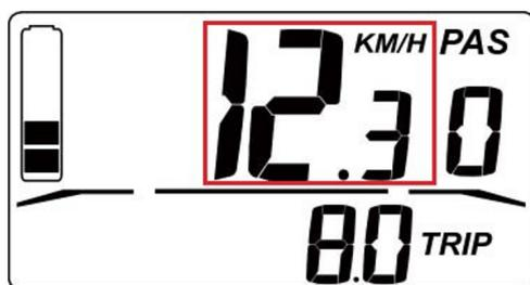
Figura 6 – Indicación de la velocidad actual en km/h.
