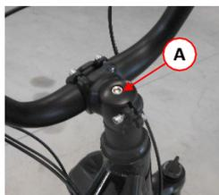
Figura 1 - Tornillo de fijación de rotación del manillar
