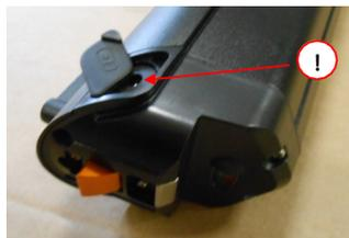
Figura 9 – Enchufe para la carga en la batería
