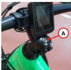
Figura 1 - Tornillo de fijación de rotación del manillar
