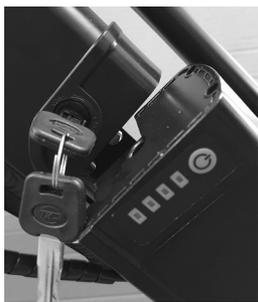
16.1. Inserire la chiave nell'apposita serratura montata sulla parte laterale della bicicletta.
